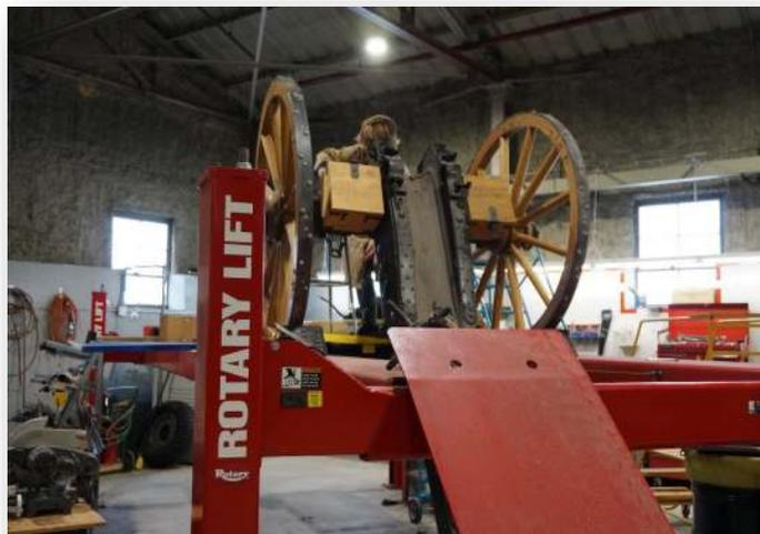
Sur la photo ci-dessus, Dayna Barscello, conservatrice adjointe, travaille sur une plateforme élévatrice de véhicule. Après avoir surélevé l'affût en position flèche au sol, elle a pu travailler plus efficacement. En effet, de cette façon, l'époxyde de conservation s'est profondément imprégné dans les fissures du bois, ce qui a consolidé le siège des dommages causés par l'accident. Bravo, Dayna! Cette pièce et quatre autres sont actuellement exposées dans notre Galerie du patrimoine.
