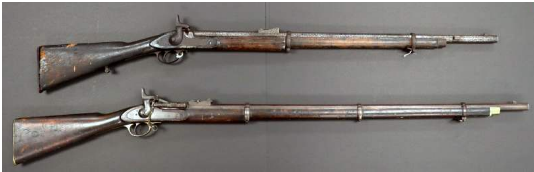
Haut : Fusil Enfield Pattern 1853; bas : Fusil Enfield Pattern 1853 converti (fusil Snider-Enfield, Mark I)
